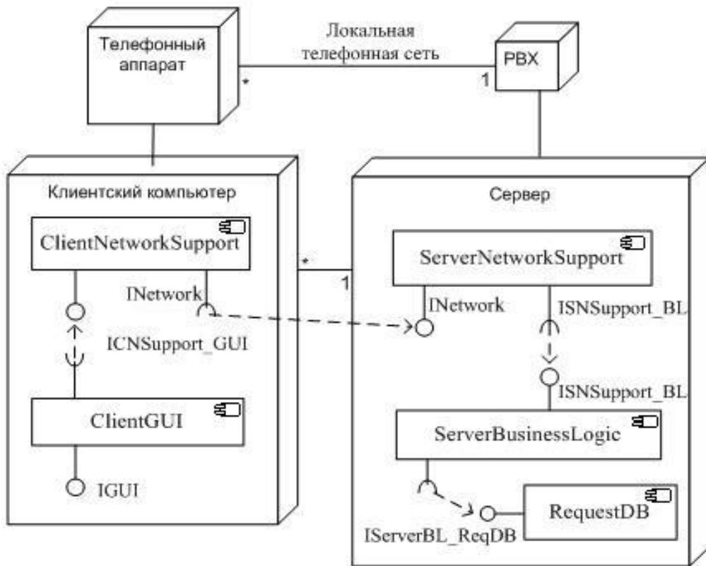
Рисунок 21 - Диаграмма развертывания, созданная в среде Borland Together
